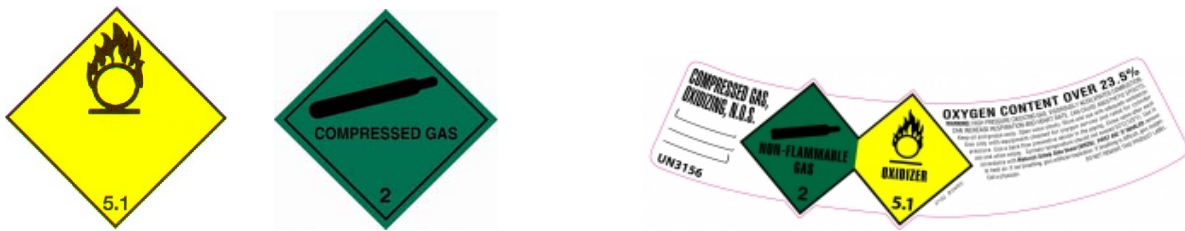
Fig 1. Aanduiding oxiderende stoffen (ADR klasse 5.1) en gecompriemd gas (ADR klasse 2) of een combinatielabel
